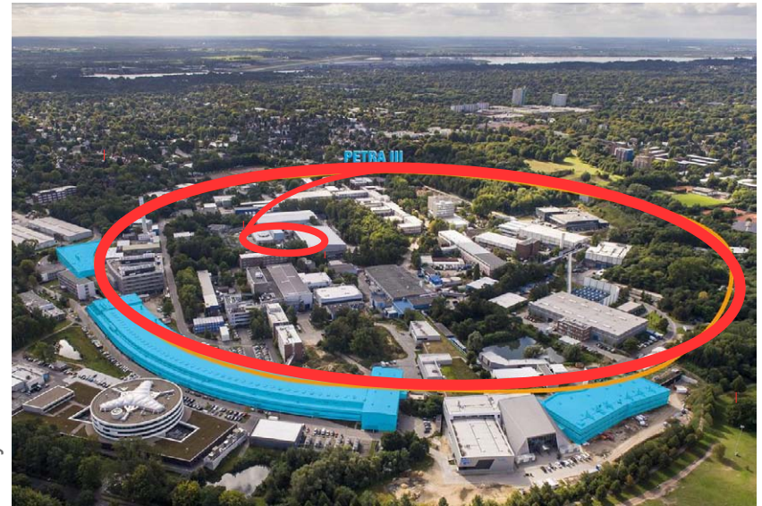
Elektronenbeschleuniger, 6 GeV, Umfang \sim 2,3 km
