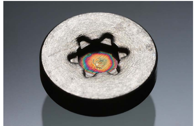
^{241}\text{Am} -Quelle aus einem Ionisations-Rauchmelder.
