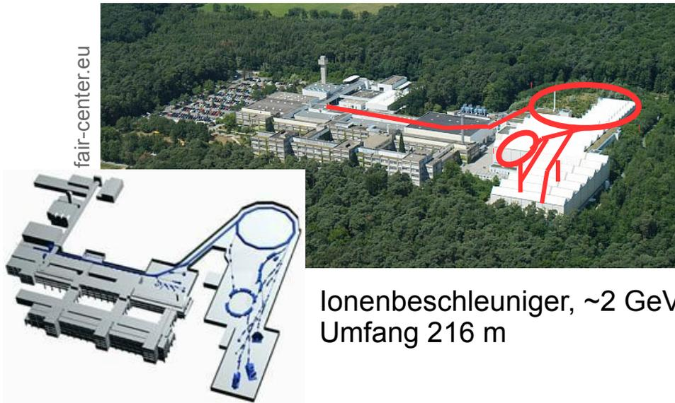
Ionenbeschleuniger,  $\sim 2$  GeV/u, Umfang 216 m
