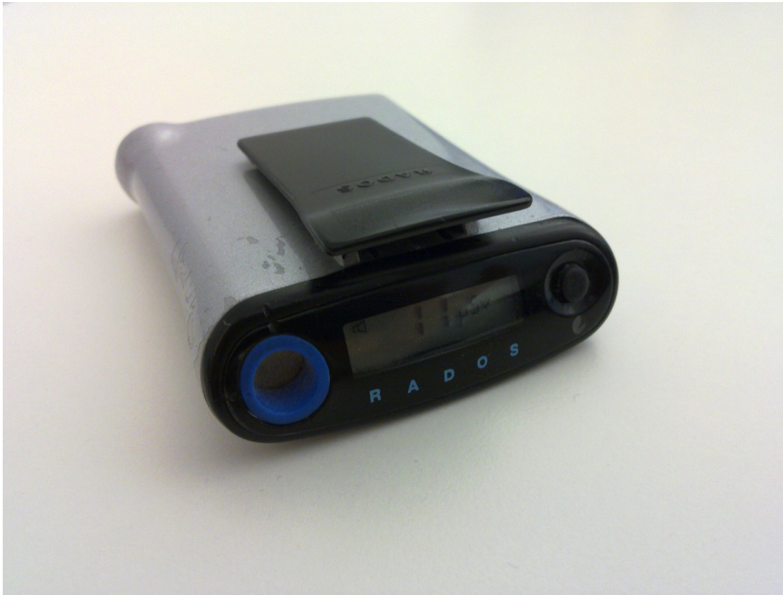
Elektronisches Dosimeter → Anzeige der aktuellen Dosisleistung
